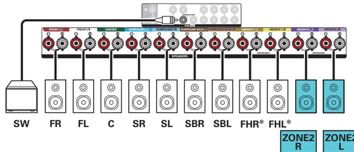
\* Les enceintes hautes, les enceintes au plafond et les enceintes Dolby Atmos Enabled peuvent être connectées sur les bornes d'enceinte HEIGHT1. Réglez les enceintes à connecter depuis "Hauteur" - "Agencement" dans le menu. (☞ p. 209)
