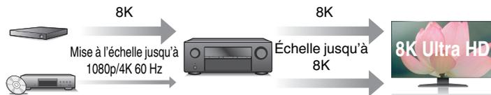
Cet appareil est équipé d'une fonction de vidéo ascendante 8K qui permet de reproduire une vidéo SD (Standard Definition) ou HD (High Definition)/4K 60 Hz en résolution HDMI à 8K (7680 × 4320 pixels). Cette fonction permet à l'appareil d'être connecté à un téléviseur à l'aide d'un simple câble HDMI, et de produire des images en haute définition pour n'importe quelle source vidéo.
