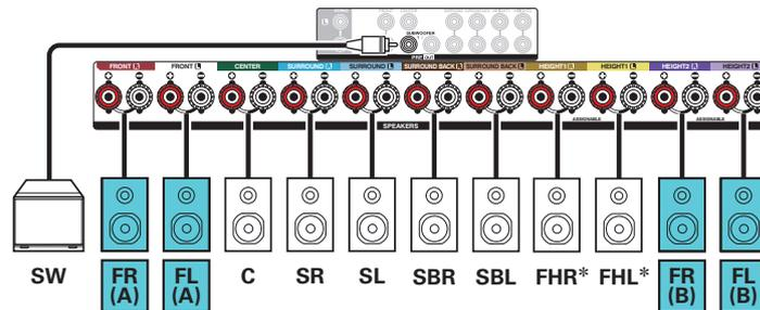
\* Les enceintes hautes, les enceintes au plafond et les enceintes Dolby Atmos Enabled peuvent être connectées sur les bornes d'enceinte HEIGHT1. Réglez les enceintes à connecter depuis "Hauteur" - "Agencement" dans le menu. (☞ p. 209)
