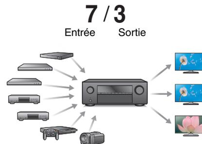
Pour la connexion à un large éventail de sources numériques, cet appareil offre 7 entrées HDMI qui vous permettent de connecter rapidement et facilement un caméscope, une console de jeux vidéo ou tout autre appareil équipé HDMI. Il y a deux sorties HDMI pour la pièce principale et une troisième sortie HDMI pour ZONE2.
